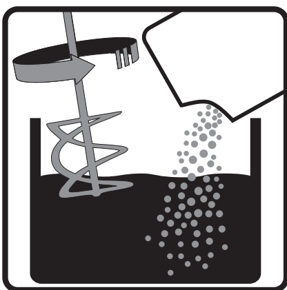
In das homogen vermischte Anmachwasser sofort und ohne Verzögerung das Mörtelpulver zugeben und homogen vermischen
