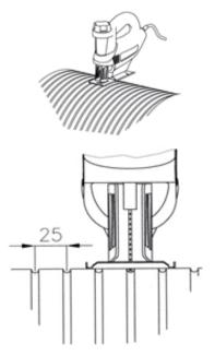
Verlängerung durch ineinander stecken möglich \* Maß kann durch Kürzen eines Zwischenrings verkleinert werden, mittels Stichsäge, Fuchsschwanz oä.
