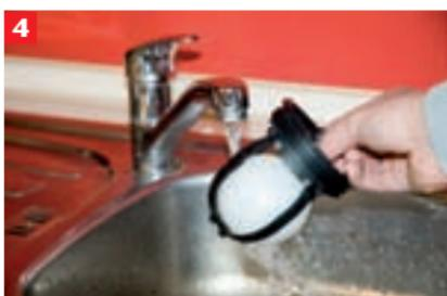
4 Rückstaeinheit und Dichtungen gründlich unter fließendem Wasser reinigen. Die Wassertemperatur darf nicht mehr als 50 °C betragen. Bitte keine chemischen und aggressiven Reinigungsmittel verwenden und nicht abkochen
