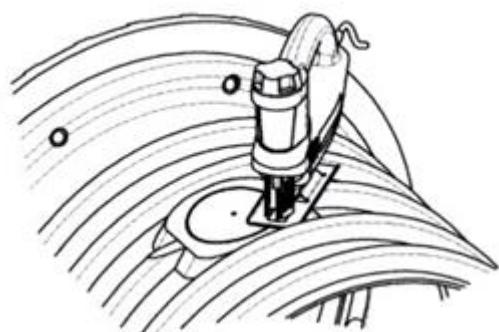
Die Anschlussflächen enthalten kreisförmige Sägemarkierungen, deren Durchmesser abgestimmt ist für den Einsatz von Lamellendichtungen DN 100 oder DN 125, siehe 1.1. Das Ausschneiden erfolgt am einfachsten mit einer passenden Lochsäge oder einer Stichsäge (siehe Abbildung).
