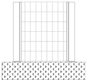
Die Multi-Anbauleiste ist abgestimmt auf Sichtschutz-Elemente der max. Höhe  $H = 180\text{cm}$ .
