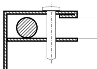
Setzen Sie das Gitter jeweils zwischen die Lasche und den Schenkel des Anschlussprofils.
