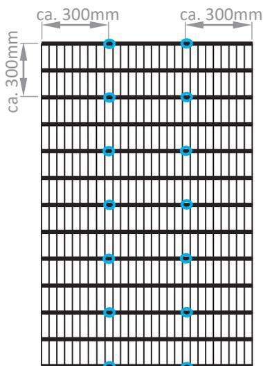
Verbinden Sie die Gitter gemäß dem gezeigten Abstandsschema mit Abstandshaken (14 Stück bei Gabione 90 x 180cm).
