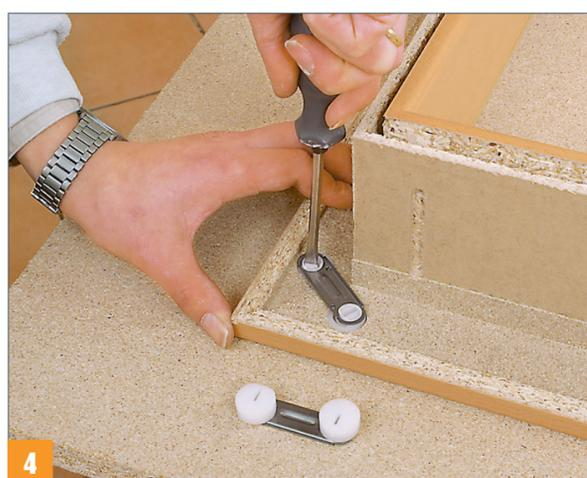
Die runden Kunststoffpropfen des Doppelsexcenters drücken Sie in die Bohrungen auf der Zargenrückseite und ziehen die Schrauben fest.
