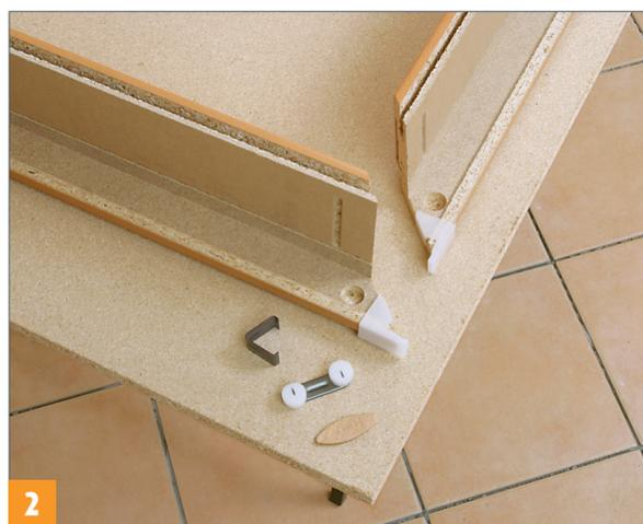
Die Zargenelemente werden durch Stahlklammern (links) und Doppelsexcenter (Mitte) sowie Flachdübel aus Holz verbunden.
