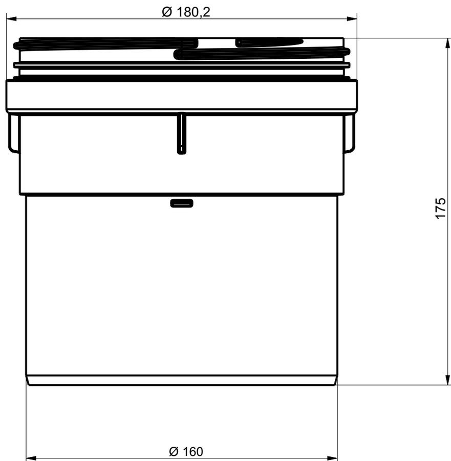
KF 7550 Flavent® pro Dämmpaketverlängerung
