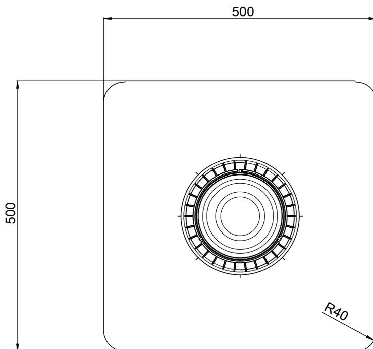
KF 7401-150 Flavent® pro Unterteil für zweiteiligen Wohnraum Be- und Entlüfter DN 150 mit Bitumen-Manschette
