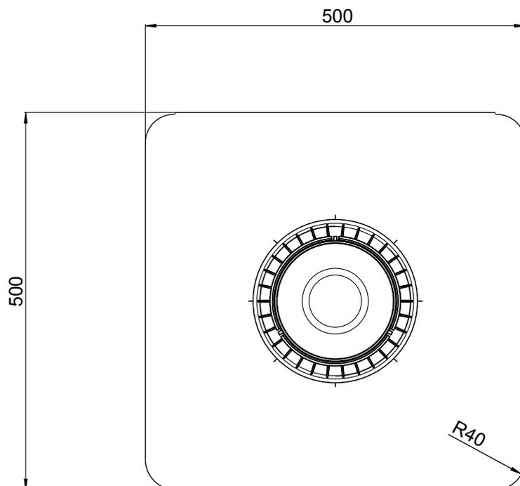
KF 7401-70 Flavent® pro Unterpart für zweiteiligen Wohnraum Be- und Entlüfter DN 70 mit Bitumen-Manschette
