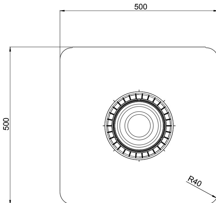
KF 7401-125 Flavent® pro Unterpart für zweiteiligen Wohnraum Be- und Entlüfter DN 125 mit Bitumen-Manschette
