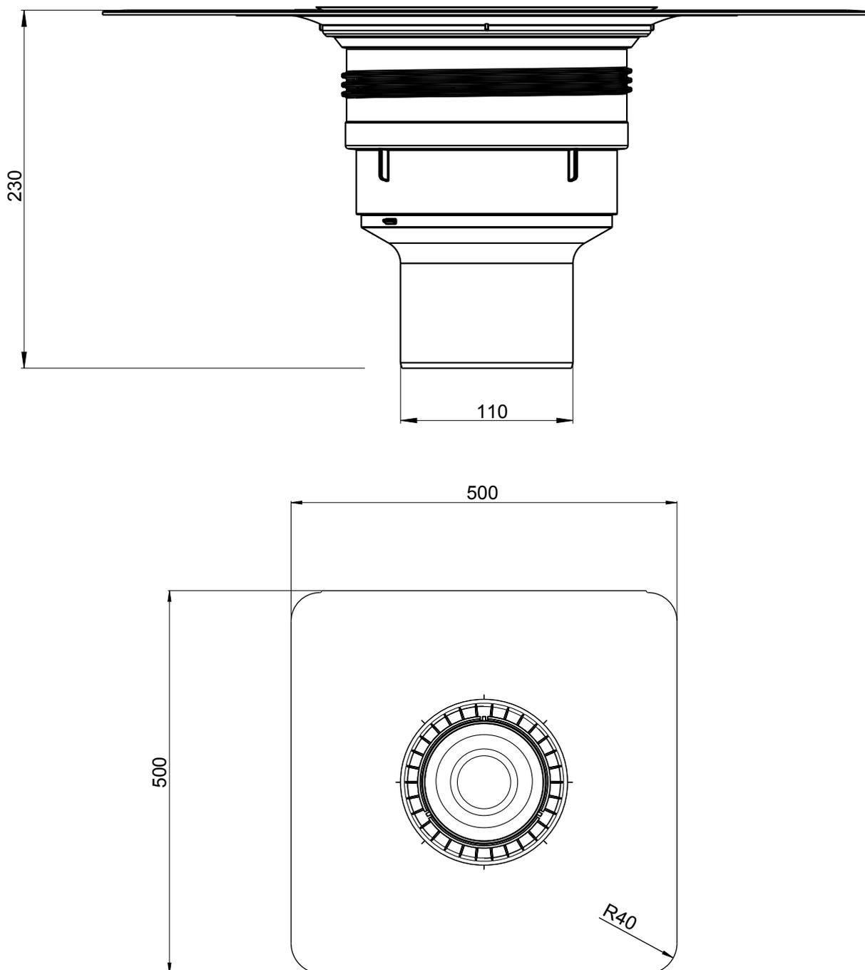
KF 7401-100 Flavent® pro Unterteil für zweiteiligen Wohnraum Be- und Entlüfter DN 100 mit Bitumen-Manschette
