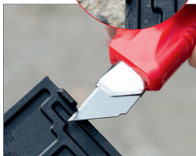
2. Klip B links und rechts mit dem Cutter entfernen
