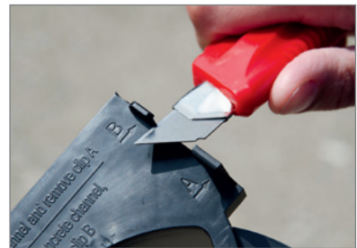
2. Klip B links und rechts mit dem Cutter entfernen
