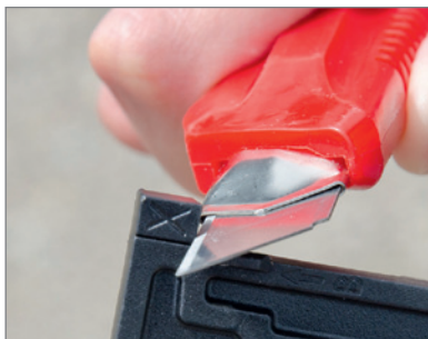
1. Bereich X links und rechts mit dem Cutter entfernen
