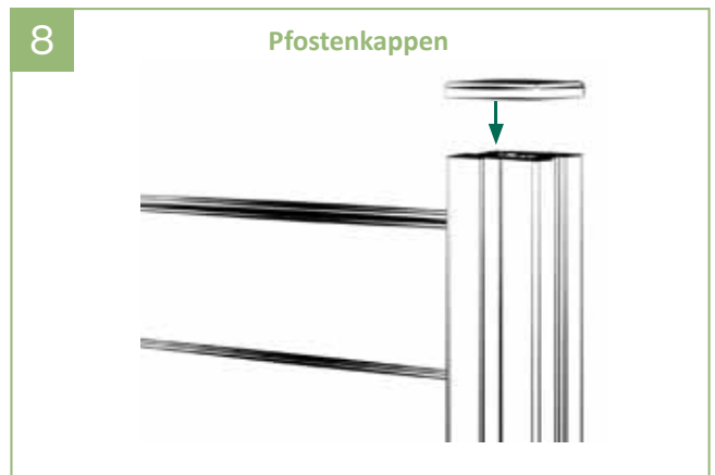
8 | Zum Schluss die Kappen auf die Pfosten setzen.
