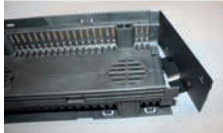
Ansetzen der Stirnwand
