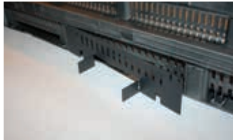
Aufstecken des Anschlussэлемэtes auf die Zapfen
