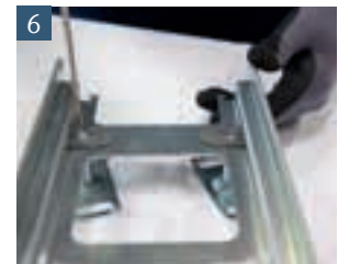
6 Schließt die Schraube mit dem Kunststoffteil oben ab, kann der Stellfuß nicht mehr herausfallen
