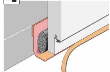
Bei Bedarf an der Falzkante bündig schneiden.
