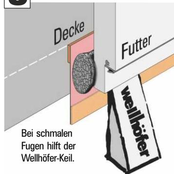
Bei schmalen Fugen hilft der Wellhöfer-Keil.
