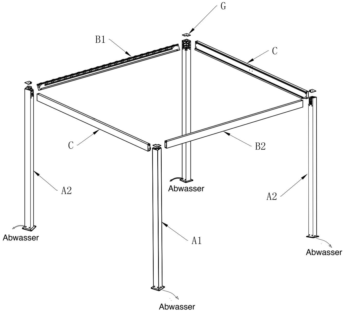
5. Die beiden Enden eines vorderen und hinteren Trägers C sind jeweils an den Eckverbindern angeordnet an der Säule und die Schrauben K1 sind festzuziehen.
