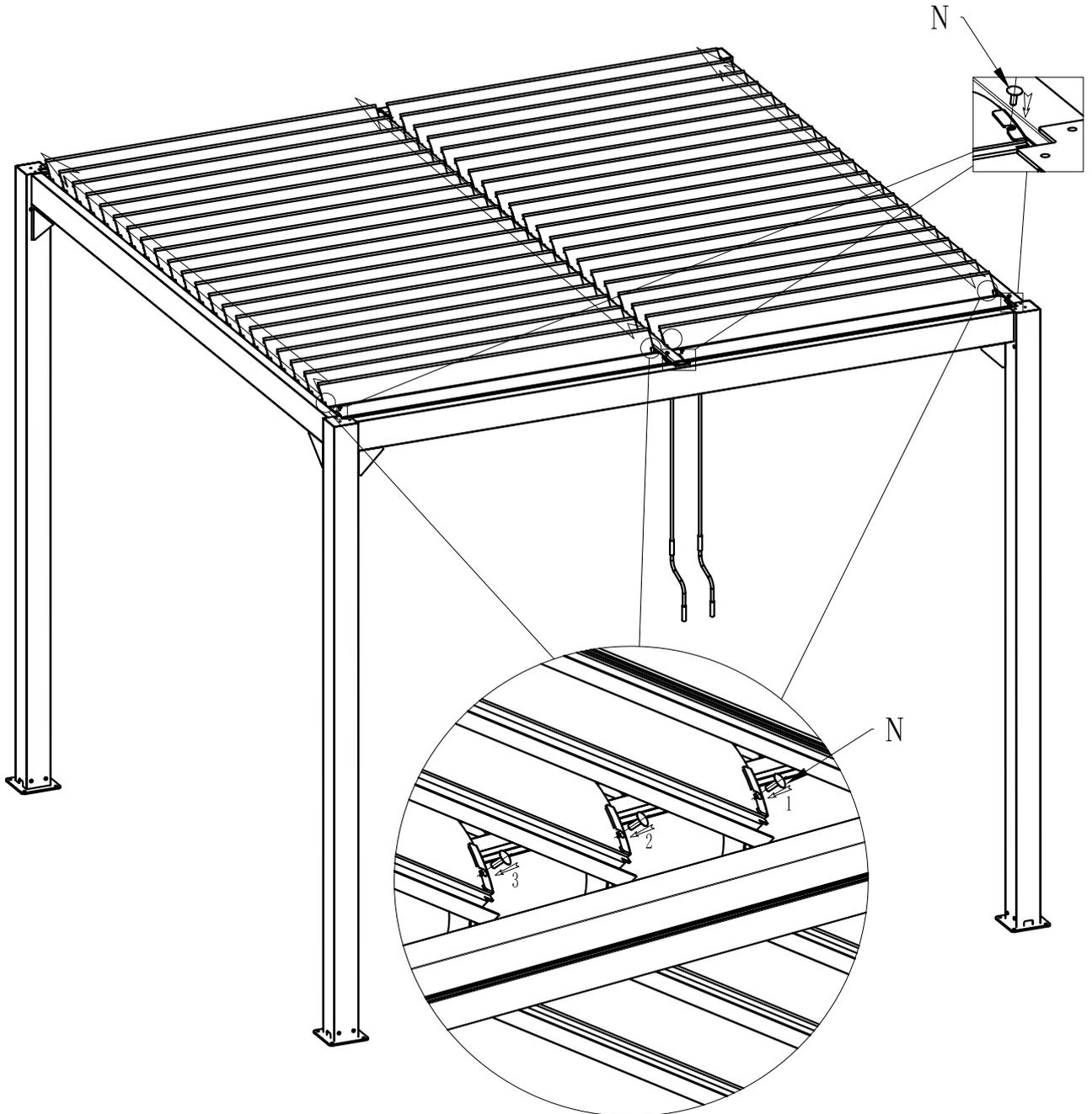
2. Drehen Sie die Klappe in die halbe Position und setzen Sie die Plastikabdeckungen N nacheinander in das Loch an zwei Enden jeder Klappe ein.
