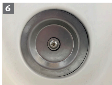
6 Die Schraubendichtung muss vollflächig und zentriert unter der Schraube liegen. Bitte darauf achten, dass die Dichtung sauber unter der Schraube liegt. Notfalls Schraube nochmals leicht lösen und erneut anziehen.
