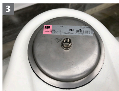
3 Unteren Deckel zentriert auf Dichtung aufsetzen
