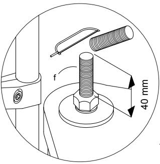
Den obersten Gewindestab (f) so kürzen, dass rd. 40 mm Gewinde überstehen.
