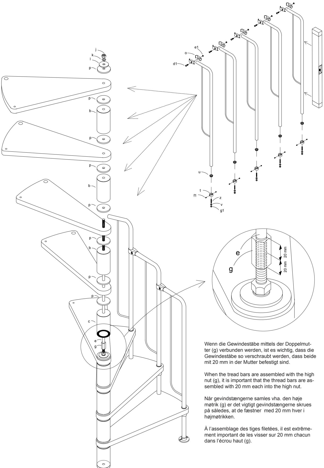
Wenn die Gewindestäbe mittels der Doppelmutter (g) verbunden werden, ist es wichtig, dass die Gewindestäbe so verschraubt werden, dass beide mit 20 mm in der Mutter befestigt sind.
