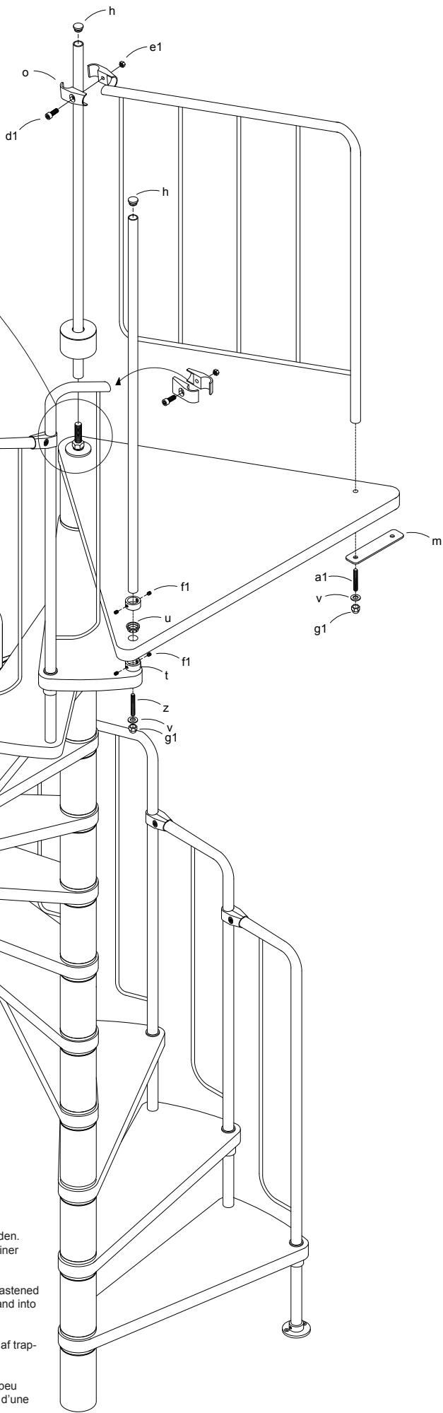
Um die Stabilität zu vergrößern kann ein Wandwinkel montiert werden. Idealerweise befestigt man auf halber Höhe den Winkel unterhalb einer Stufe und an der Wand.
